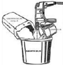
Nota: debido a las propiedades hidrofóbicas del MORTAR-LN *toma hasta 30 segundos la mezcla idónea de agua y el polvo seco.*
